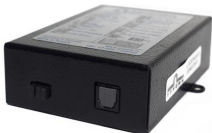
Рис.1.Адаптер MOST-TosLink 3.0 (перемычки, разъем TosLink)
