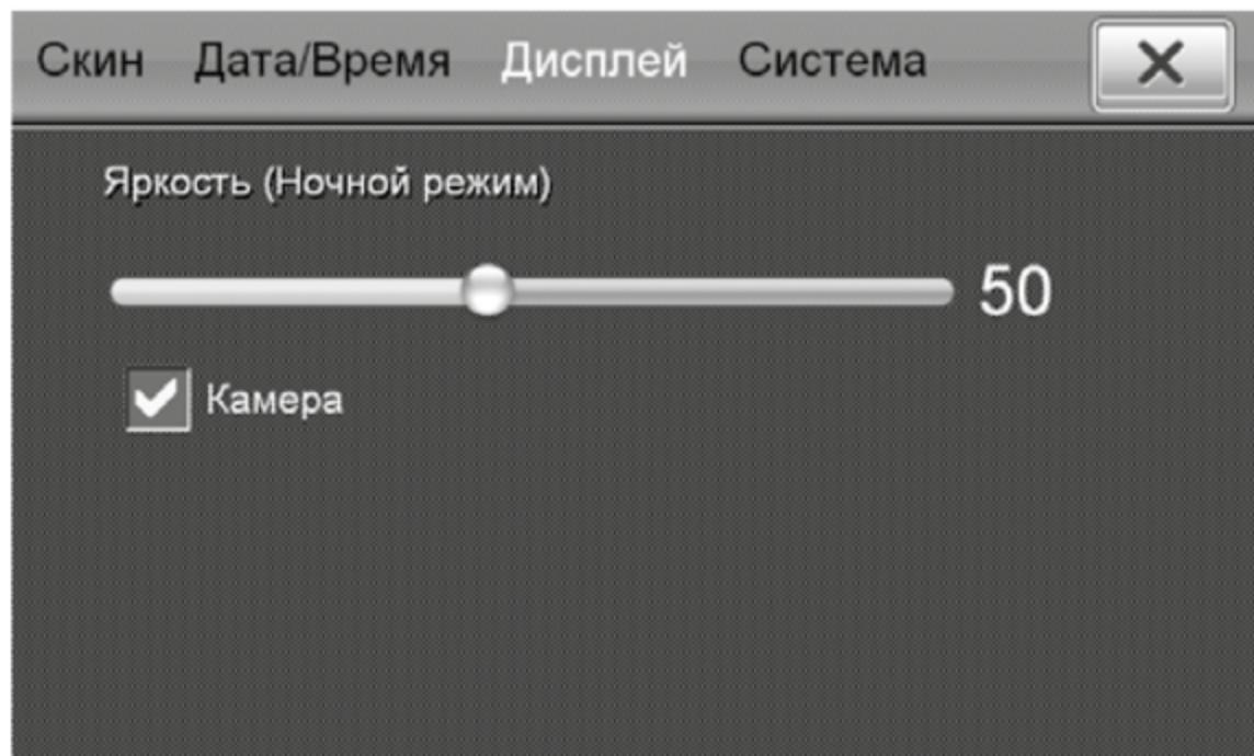
Установите галочку в поле «**Камера**», если к автомобилю подключена камера заднего вида.
