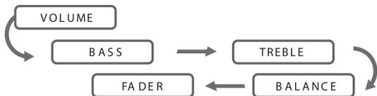
При продолжительном нажатии на регулятор громкости будут доступны следующие настройки: **LOUDNESS** (тонкомпенсатор), **EQUALIZER** (эквалайзер). После окончания настроек произойдёт автоматическое возвращение (через 5 с) в обычный режим.
